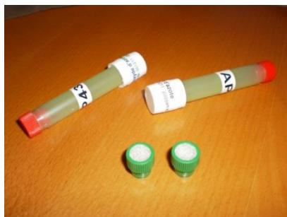
Echantillonneurs passifs PASSAM pour la mesure du dioxyde d'azote ( \text{NO}_2 ) et membranes en verre fritté installées à l'entrée de l'échantillonneur passif
